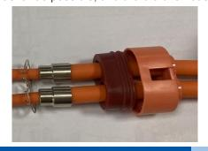
■ 步骤5:用六角刀具把③铜套压紧,压紧后铜套的保持力不少于50N
